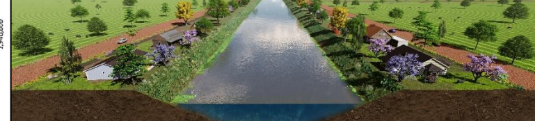
กรณีทางน้ำขนาดเล็ก มีความลึกการขุดลอกไม่เกิน 5 ม. มีการรื้อย้ายสิ่งปลูกสร้าง
