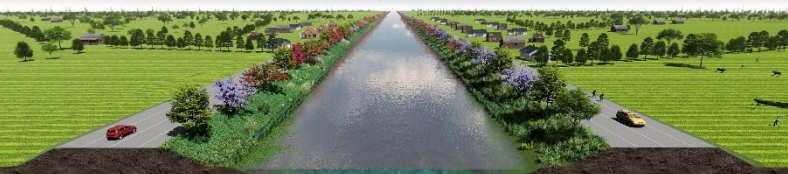
กรณีทางน้ำขนาดเล็ก มีความลึกการขุดลอกไม่เกิน 5 ม. ไม่มีสิ่งปลูกสร้าง
