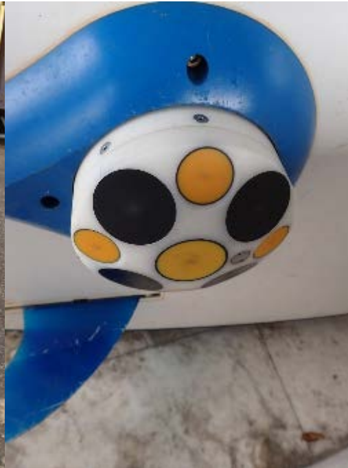
อุปกรณ์ River Ray ADCP และการติดตั้งกับเรือสำรวจ
