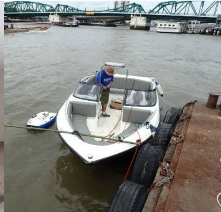
อุปกรณ์ River Ray ADCP และการติดตั้งกับเรือสำรวจ
