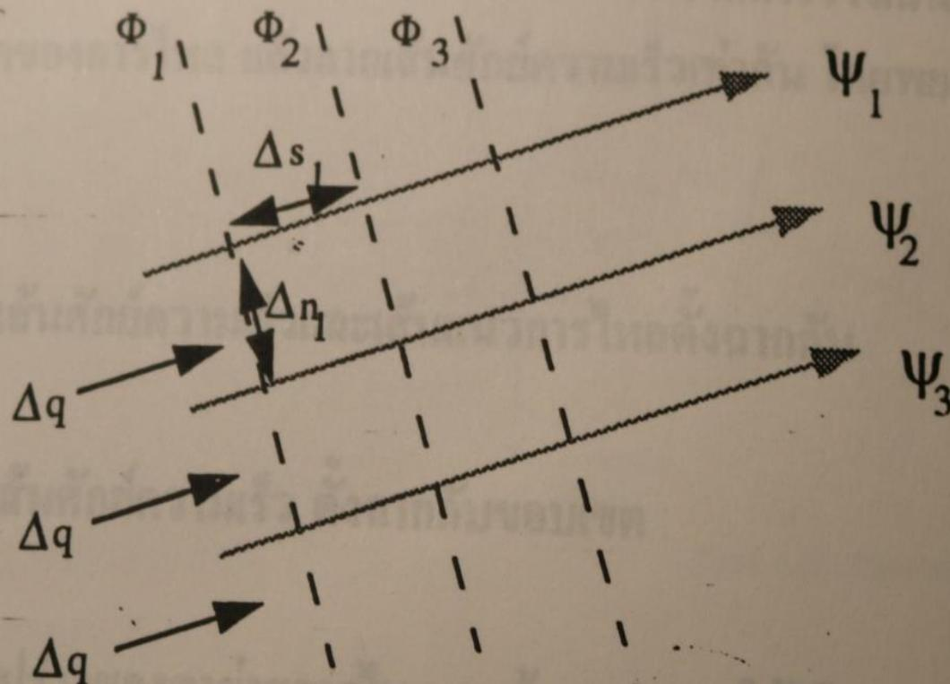
ระหว่างเส้นแนวการไหล 2 เส้น มีช่องทางการไหลเป็นลักษณะท่อการไหล (Stream Tube) ที่พิจารณาความกว้างที่ตั้งฉากกับกระดาน/หน่วย จะสามารถหาอัตราการไหลต่อหนึ่งหน่วย
