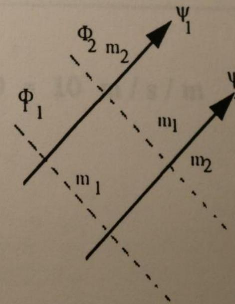
Ex เมื่อฟังก์ชันของการไหล =  $x - y$  จงหาความเร็วและทิศทางการไหลของอนุภาคของของไหลที่จุด P (1, 2)
