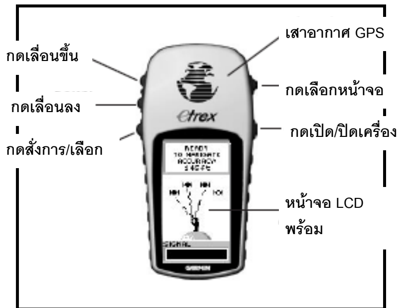
รูปที่ 2 เครื่องมือเก็บพิกัด GPS (ด้านหน้า)
